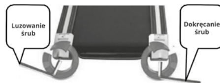
Rys. B. Metoda regulacji pasa biegowego odchylonego w prawo
