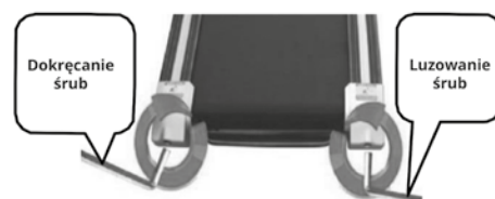
Rys. A. Metoda regulacji pasa biegowego odchylonego w lewo
